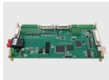
EMCC 2轴振镜焊接卡
