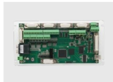
EMCC 4轴振镜焊接卡
